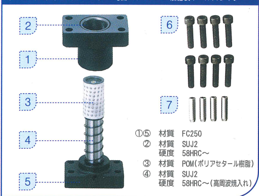
ボールダイポストセット 可動ストッパー・樹脂製ボールスライダー
